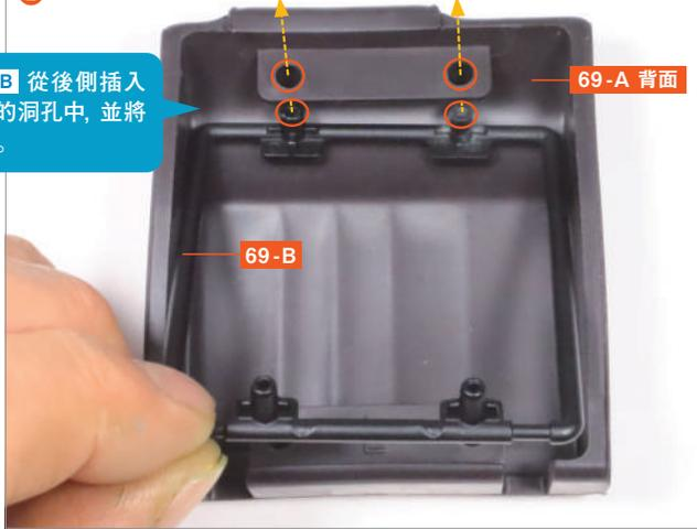
將 69-B 上方的兩個突起部分對準 69-A 上方的兩個洞孔，並嵌入固定。
