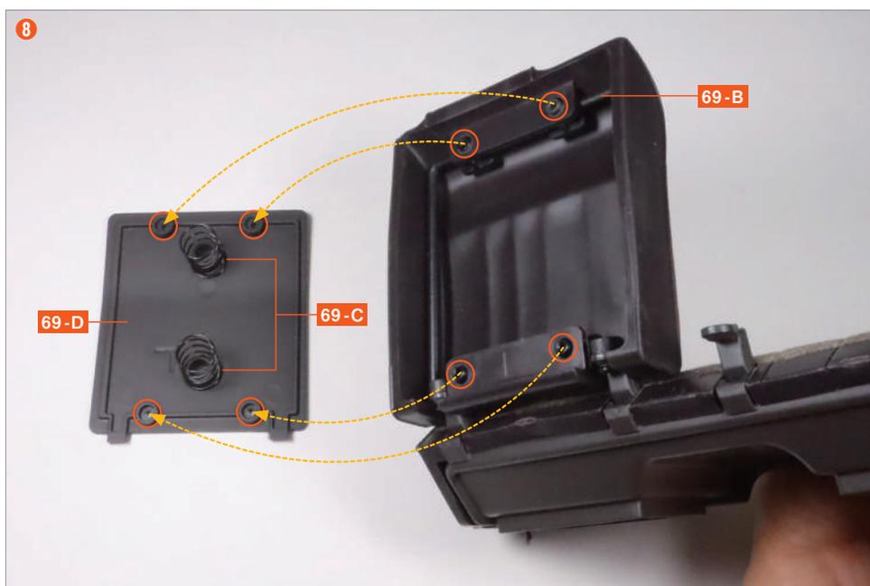
注意不要讓 **69-C** 脫落, 將 **69-B** 的四個突起部分對準 **69-D** 的凹槽並嵌入固定。
