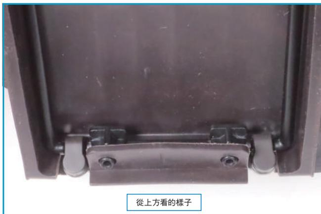
壓住兩個 **69-E** 和左右兩側的 **67-B** 以防脫落, 同時從座椅的下方使用 **AP 螺絲** 固定各部分。
